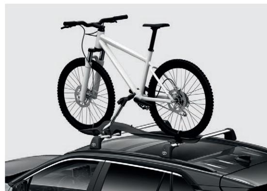
La structure légère en aluminium du **porte-vélo** est dotée d'un système antivol et de solides sangles de roues. Le bras de fixation est réglable en fonction de la hauteur du cadre de votre vélo (ou VTT).
