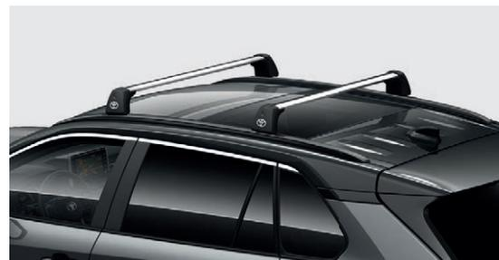
Avec les **barres de toit** en aluminium, à installer sur les rails de toit d'origine, vous pouvez bénéficier des différents systèmes de transport/portage dédiés (porte-vélos, porte-skis, coffre de toit...).
